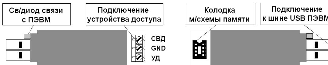
Рисунок 21 – Внешний вид программатора PROG-1 с возможностью подключения к шине USB ПЭВМ
