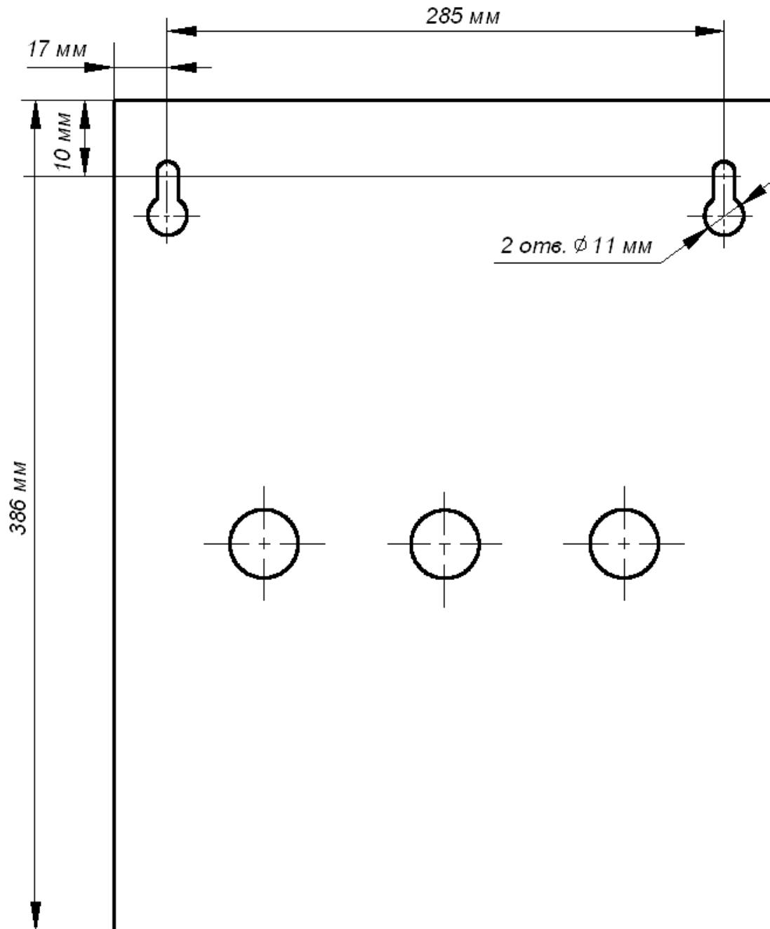
Рисунок 1 – Установочный чертеж прибора «А16-512»
