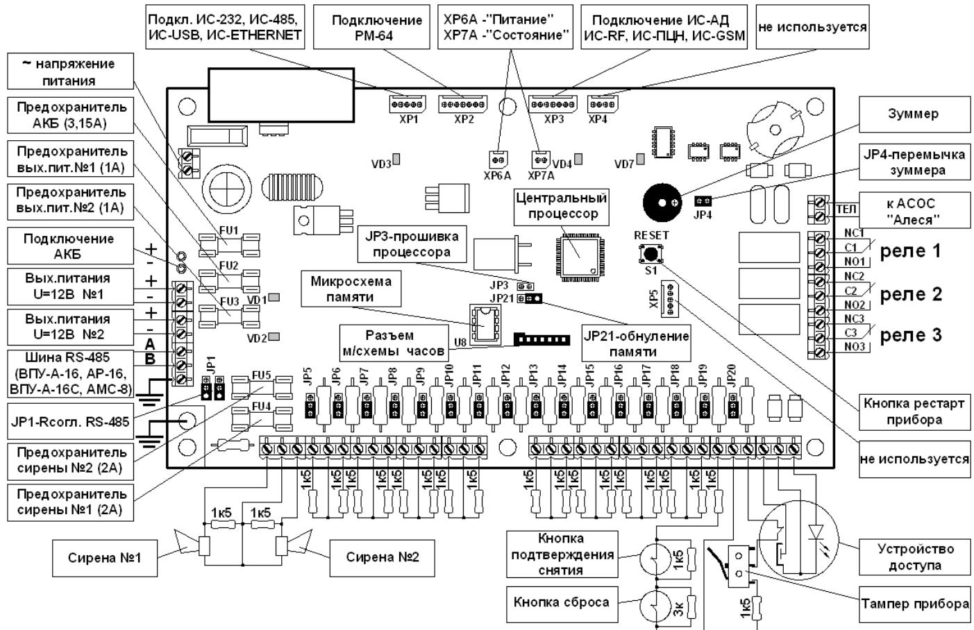
Рисунок 1 - Внешний вид платы управления «A16-512»
