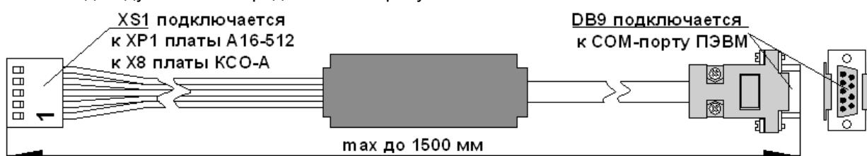
Рисунок 19 – Внешний вид модуля согласования ИС-232
