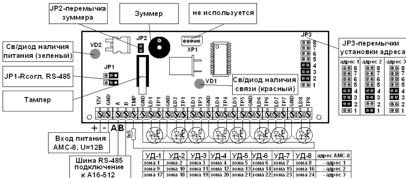
Рисунок 13 - Внешний вид модуля устройств доступа AMC-8
