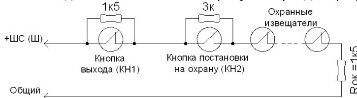
Рисунок 34 – Подключение в шлейф «Кнопки постановки на охрану» и «Кнопки выхода»
