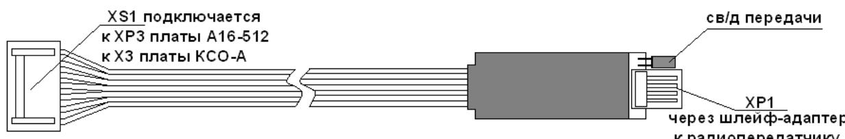
Рисунок 23 – Внешний вид модуля согласования ИС-RF при работе в составе РСПИ «МАЯК»(«STARS»), «ИРБИС»(«Cortex»), «LARS»(KP Electronic Systems), «RRT Laboratorija»
