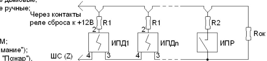
Рисунок 9 - Схема подключения дымовых 2-х проводных извещателей ИПД1, ИПДп и ручных извещателей с нормально разомкнутыми контактами в один пожарный ШС с контролем 5-ти состояний
