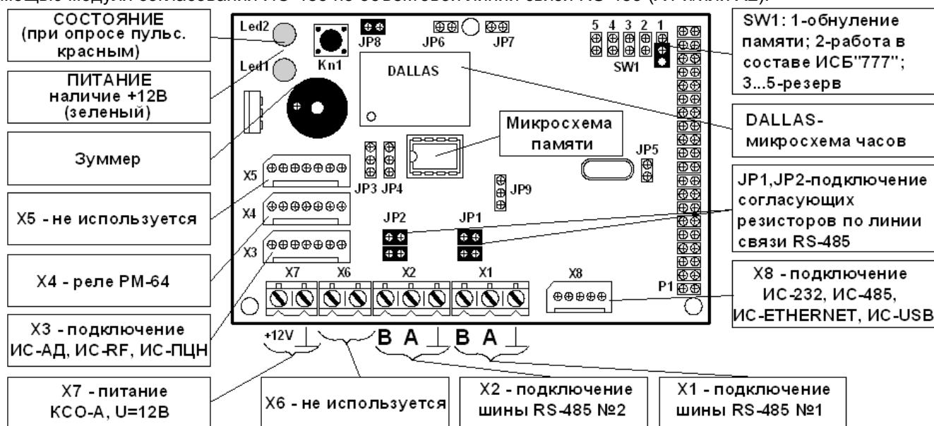
Рисунок 15 - Внешний вид модуля процессорного КСО-А
