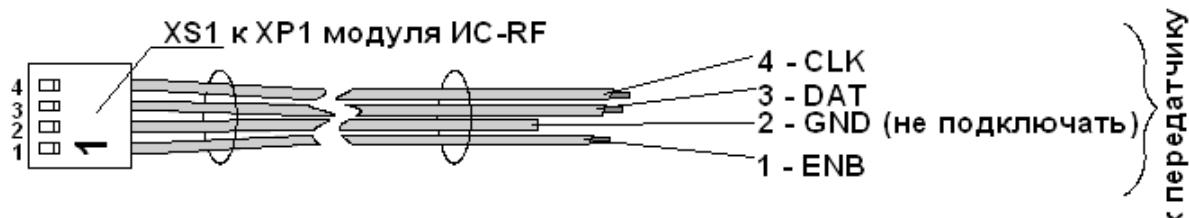
Рисунок 4 – Внешний вид шлейфа-адаптера при работе прибора «А16-512»
