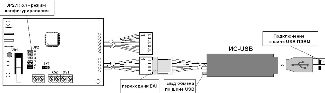
Рисунок 29 – Подключение модулей ИС-ETH/485 и ИС-USB.
