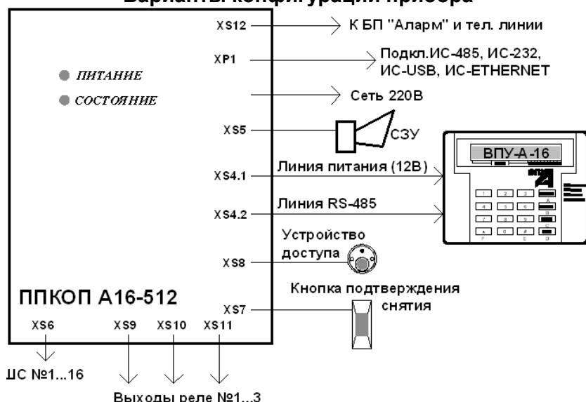
Рисунок 1 - Конфигурация прибора «A16-512» в минимальной комплектации
