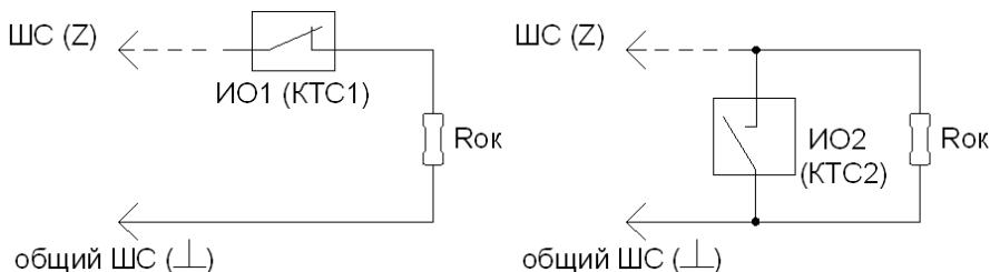
Рисунок 1 - Схема подключения охранных извещателей (кнопок тревожной сигнализации) с нормально замкнутыми и нормально разомкнутыми контактами в охранные, круглосуточные и тревожные ШС
