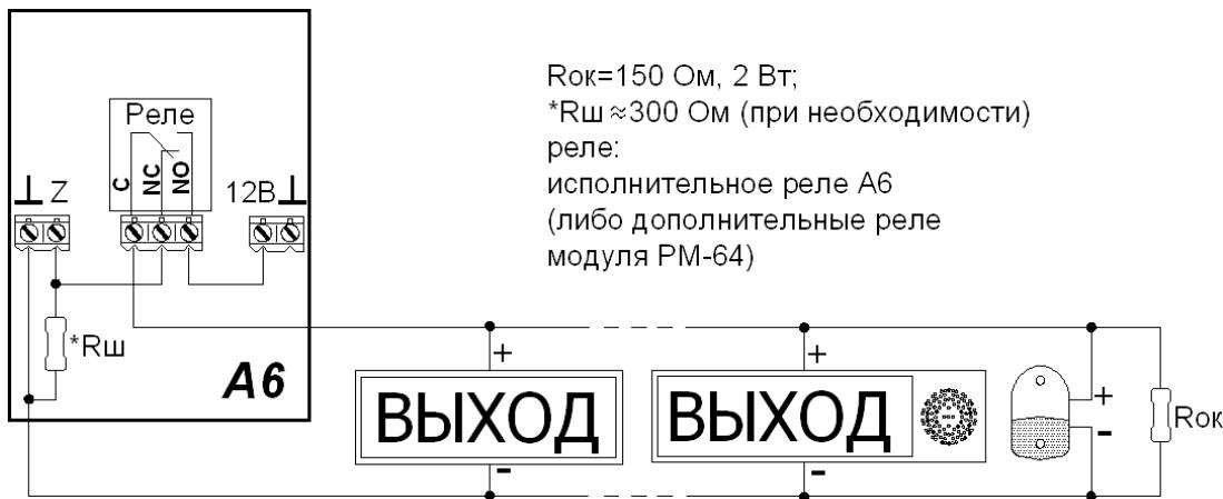
**ПРИМЕЧАНИЕ:** \*В случае необходимости исключения подработки (подсвечивания) дополнительных средств оповещения при неисправности «обрыв» части ШС рекомендуется предусмотреть подключение  $R_{ш}$
