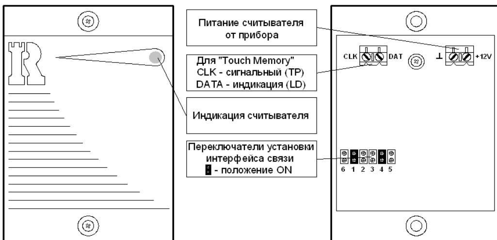
Рисунок 10 – Внешний вид выносной контрольной панели ВКП
