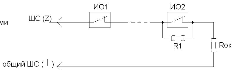
Рисунок 2 - Схема подключения охранных извещателей с нормально замкнутыми контактами в охранные ШС и круглосуточные ШС с разделением состояния тревоги: «Тревога обрыв» и «Тревога датчик»
