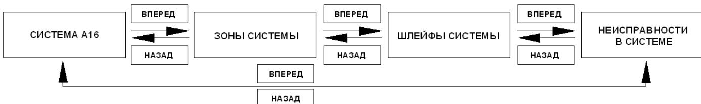
Рисунок 5 - Структурная блок-схема работы ВПУ-А-16 в режиме «Обзор»
