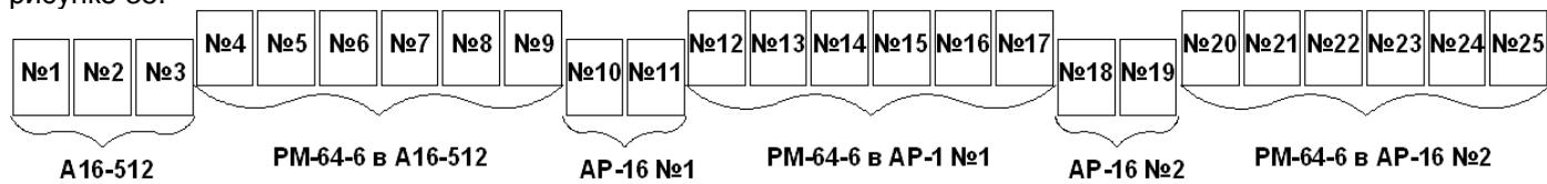
Рисунок 35 – Распределение номеров реле в ППКОП «A16-512» при подключении модулей РМ-64 и АР-16
