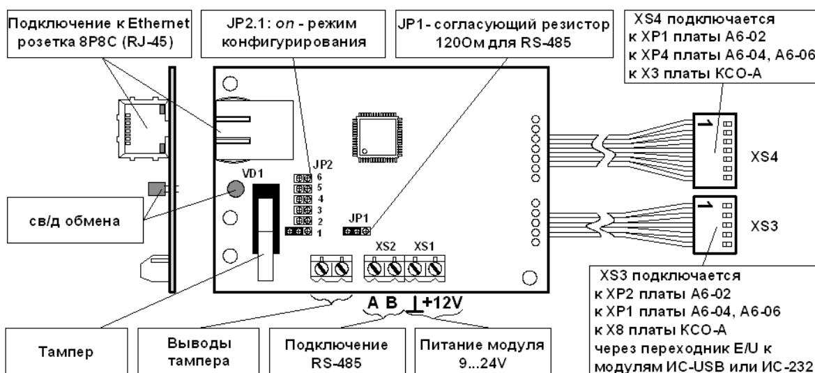
Рисунок 27 – Внешний вид модуля ИС-ETH/485.
