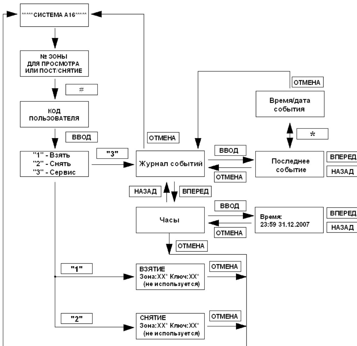
Рисунок 6 - Блок схема работы клавиатуры в режиме постановки/снятия
