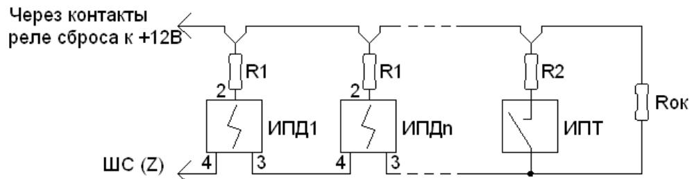
Рисунок 8 - Схема подключения дымовых 2-х проводных извещателей ИПД1, ИПДп и тепловых извещателей с нормально разомкнутыми контактами в один пожарный ШС с контролем 5-ти состояний
