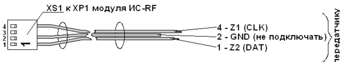
Рисунок 2 – Внешний вид шлейфа-адаптера при работе прибора «А16-512»
