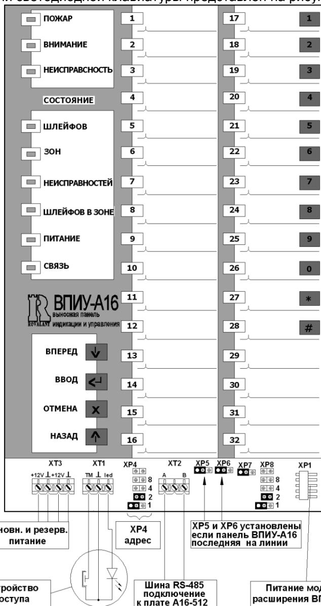
Рисунок 9 – Внешний вид выносной панели индикации и управления ВПИУ-А16
