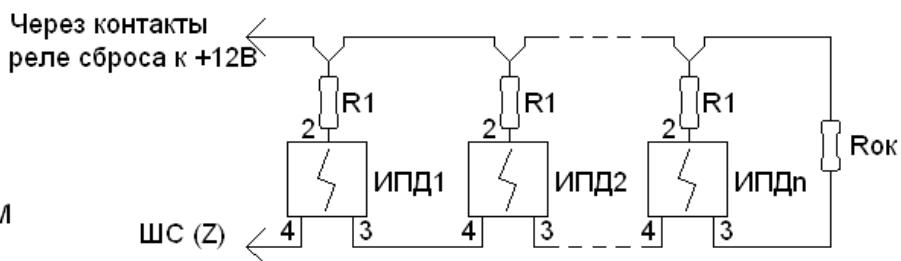
Рисунок 6 - Схема подключения дымовых 2-х проводных извещателей ИПД1, ИПД2 и ИПДп к пожарному ШС с контролем 5-ти состояний
