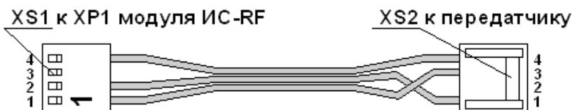
Рисунок 1 – Внешний вид шлейфа-адаптера при работе прибора «А16-512»
