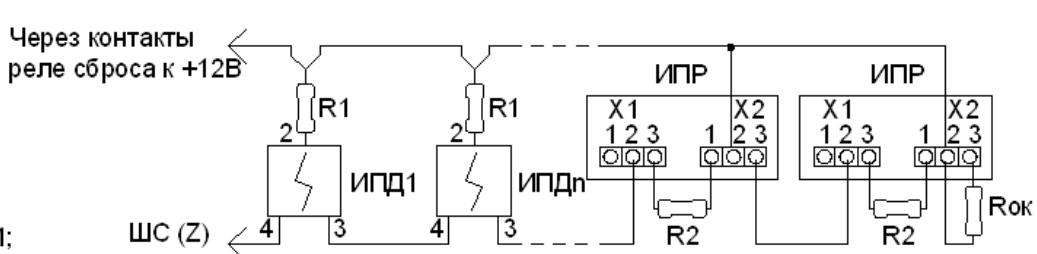
Рисунок 10 - Схема подключения ручных извещателей ИПР-3СУ и ИПР-2Р в пожарный ШС совместно с дымовыми 2-х проводными извещателями ИПД1, ИПДп, ИПР-3СУ, ИПР-2Р.
