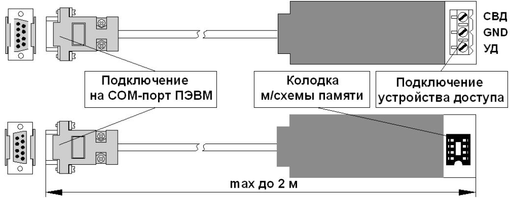
Рисунок 22 – Внешний вид программатора PROG-1 с возможностью подключения к СОМ-порту ПЭВМ
