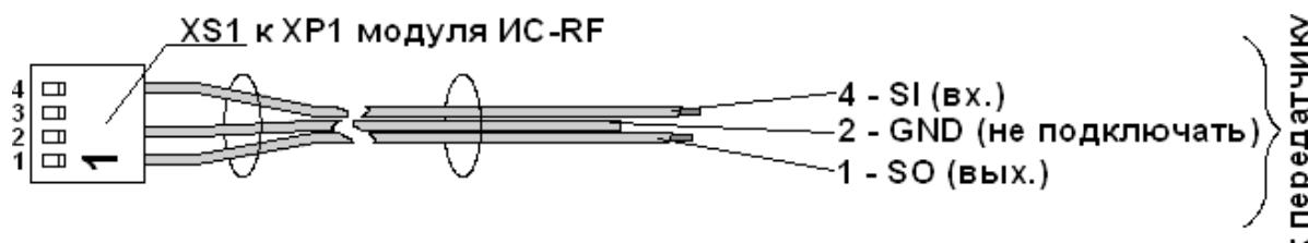
Рисунок 3 – Внешний вид шлейфа-адаптера при работе прибора «А16-512»
