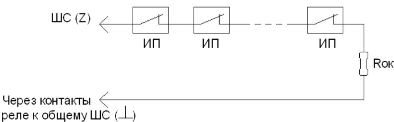
Рисунок 3 - Схема подключения пожарных извещателей с нормально замкнутыми контактами в пожарный ШС с выдачей сигнала «Пожар» при обрыве ШС
