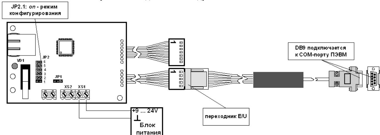
Рисунок 30 – Подключение модулей ИС-ETH/485 и ИС-232
