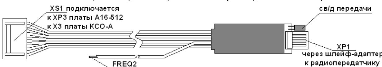
Рисунок 24 – Внешний вид модуля согласования ИС-RF при работе в составе РСПИ «Андромеда»(«PIMA»)
