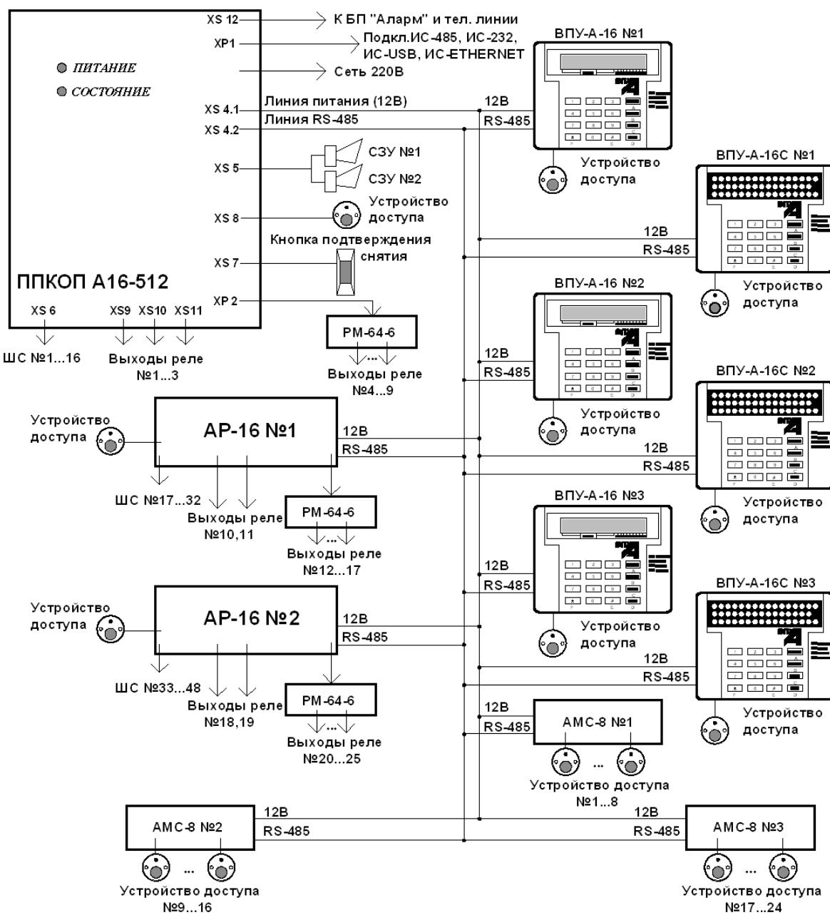
Рисунок 2 - Конфигурация прибора «A16-512» в максимальной комплектации
