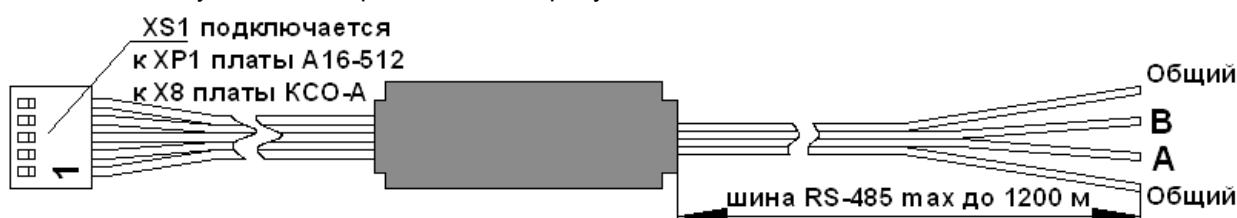
Рисунок 18 – Внешний вид модуля согласования ИС-485
