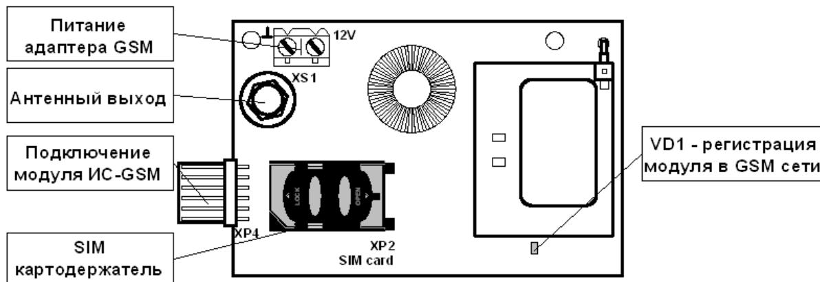
Рисунок 32 - Внешний вид Адаптера GSM
