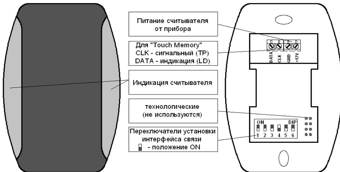
Рисунок 11 – Внешний вид выносной контрольной панели ВКП
