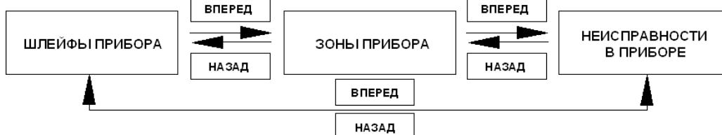
Рисунок 8 - Структурная блок-схема работы ВПУ-А-16С в режиме «Обзор»
