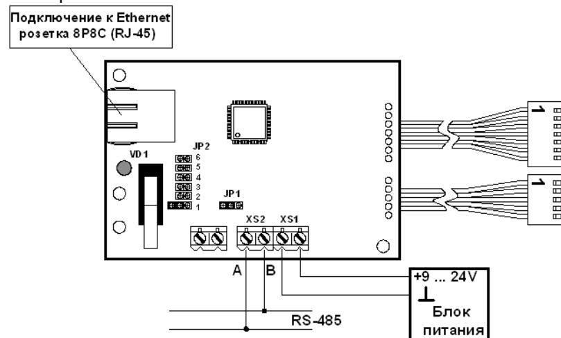
Рисунок 28 – Подключение модуля ИС-ETH/485 к RS-485.
